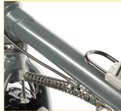
Unbeladen eher störrisch, beladen sehr hilfreich: der Lenkungsämpfer.
