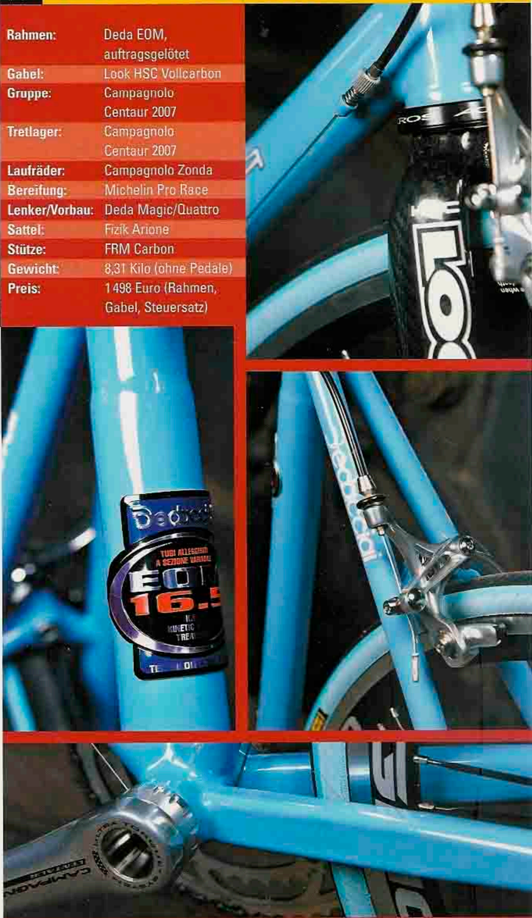
Aus dem EOM-Rohrsatz von Deda fertigt Riccorsa einen supersteifen Rahmen. Die himmelblaue Pulverschicht ist schön und schlagzäh; mit farblich passenden Reifen und Campagnolos neuer Centaur-Gruppe entsteht ein stylicher Renner mit wirklich perfekten Fahreigenschaften dank akkurater Umsetzung der Geometriewünsche.
