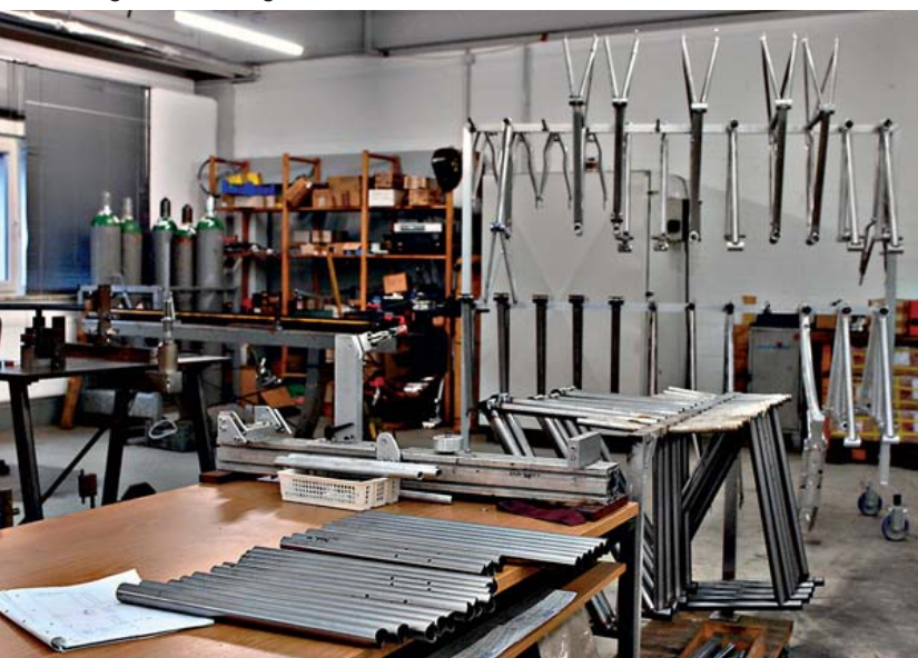
Platz für die Produktion: Von den zugeschnittenen Rahmenrohren auf dem Tisch bis zu den fertig geschweißten Agresti-Stahlrahmen am Ständer
