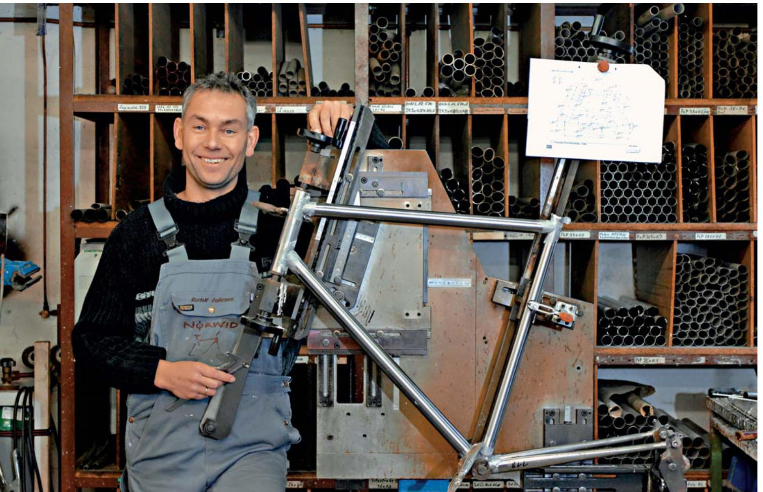
Über Umwege zum Stahl: Rudolf Pallesen an seiner Rahmenbau-Lehre; dort wird der Stahlrahmen vermessen und zum Löten vorbereitet
