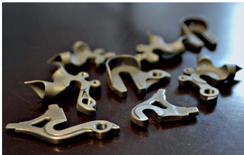
Vielfalt durch Stahl: So unterschiedliche Ausfallenden lassen sich nicht aus Carbon oder Aluminium herstellen
